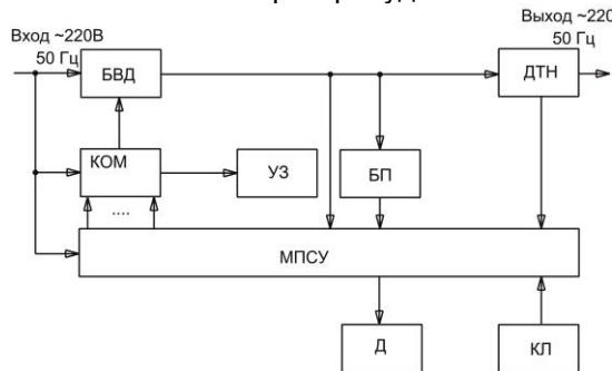
БВД – блок вольтодобавки; КОМ – коммутатор; МПСУ – микропроцессорная система управления; БП – блок питания; УЗ – устройство защиты; Д – дисплей цифровой; ДТН – датчик тока нагрузки; КЛ – клавиатура
