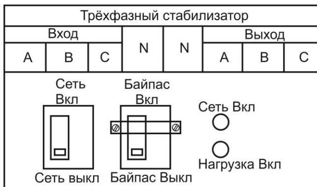
*Рисунок 3 – Маркировка силовых контактов для подключения*
