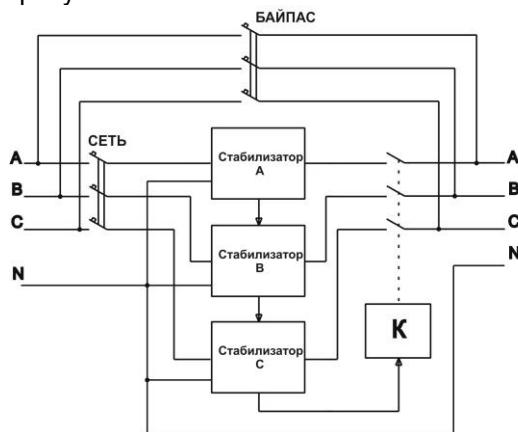
К – контактор трёхфазного выхода срабатывает при условии функционирования всех трёх стабилизаторов.
